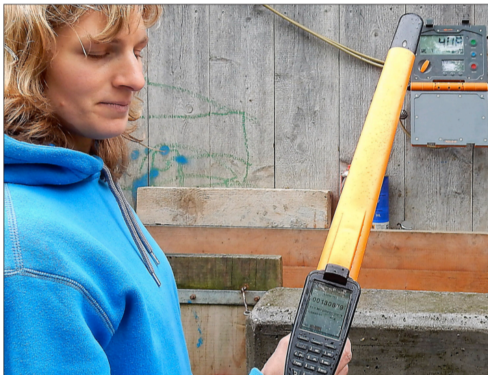
Mit der Tastatur im Erfassungsgerät können weitere Daten eingegeben werden. Im Hintergrund die Anzeige der Tierwaage.
